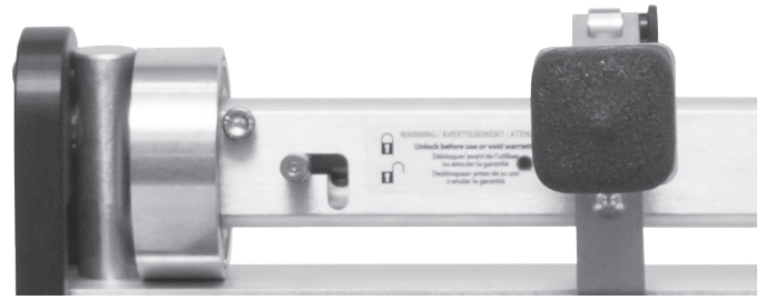
INMOVILIZADOR DE LEVA EN POSICIÓN BLOQUEADA
