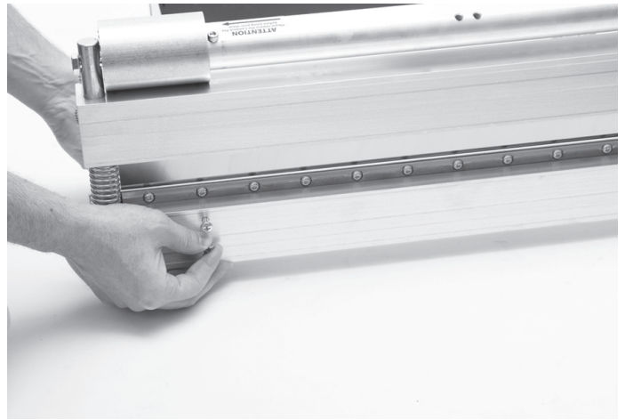
4. Schneiderbaugruppe (B) mit Schraubensatz (H) an der Auflagenstrebe (C) befestigen.
