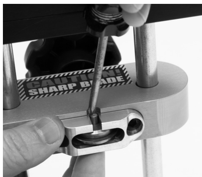
Étape 6 – Centrer l'axe à l'aide d'un tournevis ou d'une stylo.
